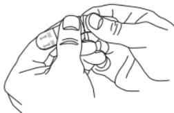
3. Remueva el revestimiento rojo. Presione la cinta adhesiva en una de las esquinas superiores de la parte posterior de la antena. Repita para la otra esquina superior. Luego coloque una tira de montaje sencilla en la sección de metal en la parte inferior central de la antena, con la tira boca abajo.
