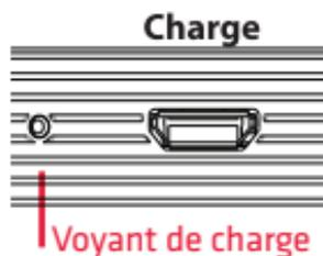
**La prise de charge** se connecte au câble fourni la prise de Charge USB pour brancher le haut-parleur dans une source d'alimentation ou un adaptateur.
