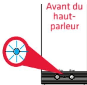
Si votre téléphone ou tout autre appareil Bluetooth a été apparié antérieurement au haut-parleur, celui-ci, lorsqu'il est allumé, essaie automatiquement de se reconnecter à cet appareil. Pour appairer le haut parleur à un autre appareil, appuyer rapidement sur le bouton Power/Pair. Le haut-parleur émet un signal audio et le voyant à l'avant du haut-parleur clignote.
