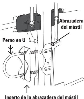
Encuentre el perno en U y el inserto de la abrazadera del mástil (vea la ilustración a la izquierda). Instale el perno en U en el inserto de la abrazadera del mástil de manera que los dientes del inserto de la abrazadera queden orientados hacia el lado cerrado del perno en U.
