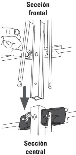
En la sección frontal (la que desdobló en el paso 5), encuentre la palabra “Front” impresa de color rojo en el brazo. Encuentre la misma palabra impresa en el brazo de la sección central. Alinee ambos brazos de manera que las palabras impresas queden orientadas hacia usted.
