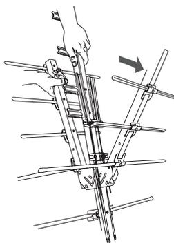
Una vez haya desdoblado todos los elementos de los brazos del reflector, extiéndalos y aléjelos del brazo principal hasta que queden fijos en su posición.
