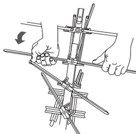
Cada brazo del reflector consta de cuatro elementos. Desdóblelos ligeramente. Luego, comenzando con el elemento más próximo al brazo principal, desdoble el elemento hasta que quede fijo en su posición.
