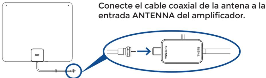
Conecte el cable coaxial de la antena a la entrada ANTENNA del amplificador.
