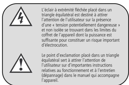
L'éclair à extrémité fléchée placé dans un triangle équilatéral est destiné à attirer l'attention de l'utilisateur sur la présence d'une « tension potentiellement dangereuse » et non isolée se trouvant dans les limites du coffret de l'appareil dont la puissance est suffisante pour constituer un risque important d'électrocution.
