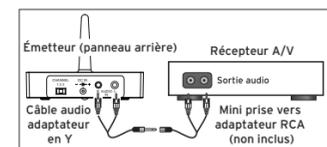
1. Branchez les fiches stéréo sur le câble audio pour adaptateur en Y dans les prises AUDIO IN à l'arrière de l'émetteur (assurez-vous de faire correspondre les couleurs des fiches avec celles des prises).
