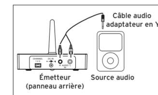
1. Branchez les fiches stéréo sur le câble audio pour adaptateur en Y dans les prises AUDIO IN à l'arrière de l'émetteur (assurez-vous de faire correspondre les couleurs des fiches et des prises).
