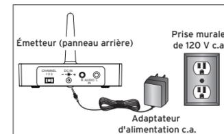
**Nota :** L'émetteur ne comporte aucun interrupteur de MARCHE / ARRÊT. L'émetteur est conçu pour être le branché et alimenté en tout temps. Si vous prévoyez de ne pas utiliser le AWS6 pendant une période de temps prolongée, débranchez l'adaptateur d'alimentation c.a. de l'émetteur.
