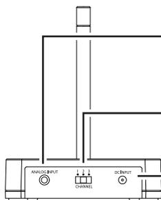
Le **câble d'entrée audio** se raccorde à la source sonore grâce à une des options de connexion décrites aux pages suivantes
