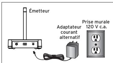
Brancher la petite fiche ronde de l'adaptateur courant alternatif de l'émetteur dans la prise d'entrée d'alimentation de celui-ci. Brancher l'autre extrémité de l'adaptateur courant alternatif de l'émetteur dans n'importe quelle prise murale 120 V c.a.
