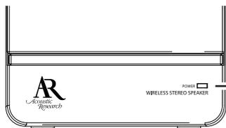
Le témoin **POWER** s'allume en rouge lorsque le haut-parleur est mis sous tension et devient bleu quand celui-ci est synchronisé avec l'émetteur
