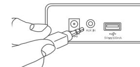
Utilice un cable de audio miniconector (no incluido) para conectar la salida de audio del dispositivo a la entrada de audio en la parte posterior de la unidad ARS70.
