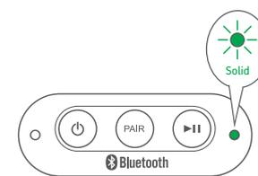
La luz indicadora en el lado derecho de la unidad ARS70 se torna color verde cuando algún dispositivo se encuentra conectado a la entrada auxiliar. La unidad ARS70 cambiará de modo predeterminado a la entrada auxiliar cuando algún dispositivo se encuentre acoplado al conector AUX IN. Si desea escuchar la reproducción vía Bluetooth, deberá desconectar el cable de conector AUX IN en la unidad ARS70.
