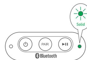
Le voyant situé sur le côté droit de la partie supérieure du ARS70 devient vert lorsqu'un dispositif est connecté à l'entrée auxiliaire. Le ARS70 par défaut établit la connexion vers cette entrée auxiliaire lorsqu'un dispositif est branché dans la prise AUX IN. Pour une lecture en mode Bluetooth, il est nécessaire de débrancher le câble de la prise AUX IN du ARS70.
