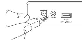
Utilisez un câble audio mini-jack (non inclus) pour connecter la sortie audio de votre appareil à l'entrée audio située sur le panneau arrière du ARS70.
