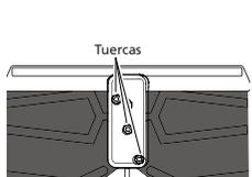
3. Inserte tres tornillos en los orificios ubicados en el lado exterior de la parte superior de la sección central. Mantenga los tornillos en su lugar y voltee la parte superior de la sección central. Colóquela sobre una superficie plana.
